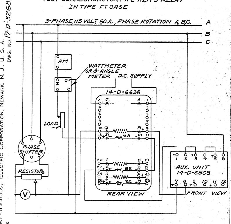
CONNECTIONS SHOWN FOR TEST OF ONE ELEMENT ONLY
